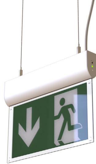
A FOLLOW ME EVO é uma luminária de indicação de saída de emergência com pictograma de leitura dupla face. Permite a instalação no teto de forma SALIENTE, ENCASTRADA, SUSPensa ou aplicada na PAREDE. O corpo é em alumínio com acabamento termolacado branco e o painel retroiluminado é em acrílico transparente, onde é aplicado o pictograma que sinaliza a saída.
