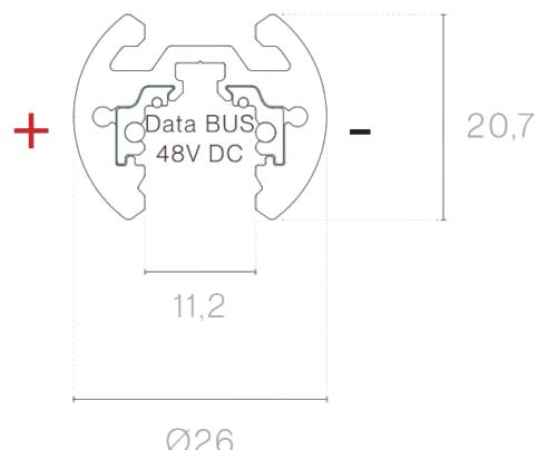
**MT15 - CALHA 48V MICRO****TABELA DE PRODUTO E ESPECIFICAÇÕES TÉCNICAS - MT15 - Calha 48V MICRO suspensa**
