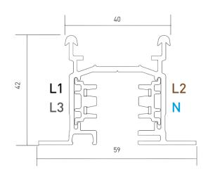
CALHA 230V ENCAST. ON/OFF
