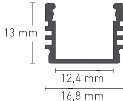
**LP02 PERFIL DE ALUMÍNIO****TABELA DE PRODUTO E ESPECIFICAÇÕES TÉCNICAS - LP02 Perfil de alumínio 2000mm x 16,80mm x 13mm - para fita LED de até 12mm**
