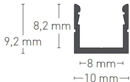
OP16 PERFIL DE ALUMÍNIOTABELA DE PRODUTO E ESPECIFICAÇÕES TÉCNICAS - OP16 Perfil de alumínio - 2000mm x 10mm x 9,2mm - para fita LED de até 8mm
